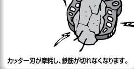
カッター刃が摩耗し、鉄筋が切れなくなります。
