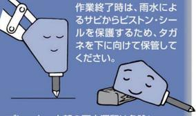
作業終了時は、雨水によるサビからピストン・シールを保護するため、タガネを下に向けて保管してください。
