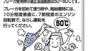
ブレーカ使用時の適正油温範囲は50～80℃です。ブレーカを初めて使う時や、毎始業時には、10分程度垂直に、7割程度のエンジン回転数で、ならし運転を行ってください。
